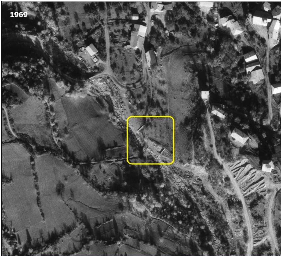
Des éléments perpendiculaires au torrent ont été réalisés en rive droite au-dessus du pont, probablement la réponse à ce qui s'est produit quelques années plus tôt. Ils étaient déjà perceptibles en 1967.
